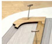
**Step 45 - Vertical Fin Assembly (VF3, VF4A, VF4B)**
